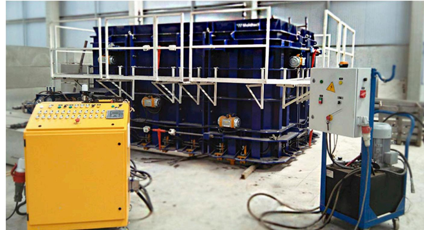
Les éléments et différentes pièces qui forment le MT20 sont usinés pour obtenir un ajustement et un alignement parfaits.
